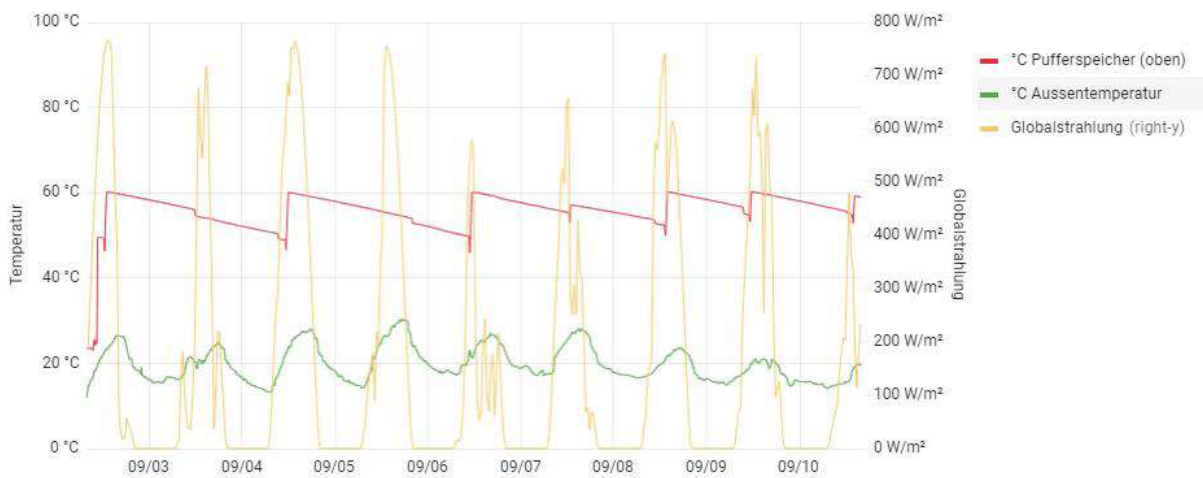
Abb. 2: Messung der Pufferspeichertemperatur der mit einem EMS zur PV-Eigenverbrauchsoptimierung fälschlicherweise im Sommer beladen wird.
